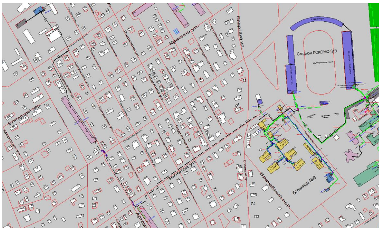
Рисунок 1.39 Результат гидравлического расчета - расчетный путь теплоносителя от котельной Климовская, 86а до ПТ-Клим,3
