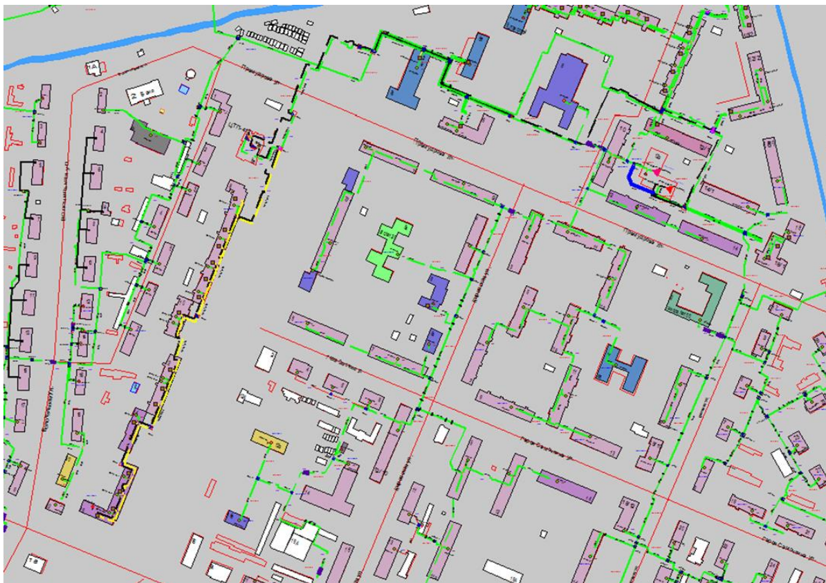
Рисунок 1.109 Результат гидравлического расчета - расчетный путь теплоносителя от котельной Премудрова, 12а до ПТ-Днепр,16 э4
